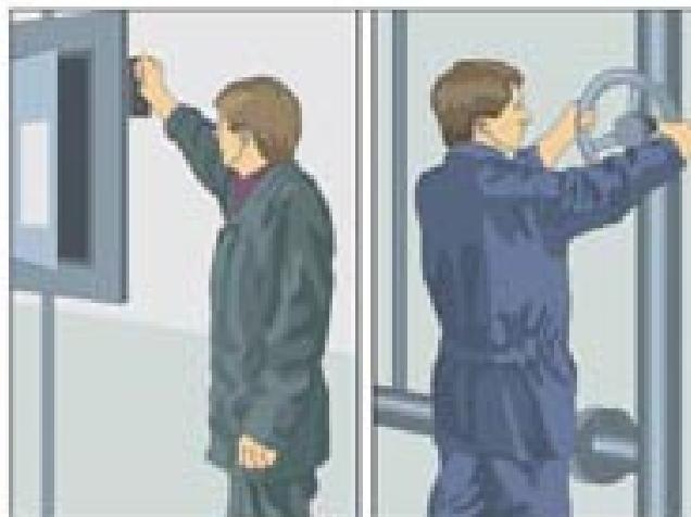
По команде руководителя аварийно остановить производство (оборудование). Отключить вентиляцию и электрооборудование. Перекрыть краны и задвижки на трубопроводах подачи газа, масла, агрессивных и горючих жидкостей. Открыть задвижки для их слива в аварийные баки
